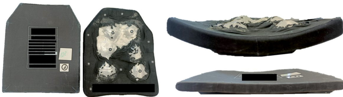
Obr. 1 Ukázka poškození plátu s potenciálem BABT
