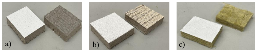
Obr. 1 Fotodokumentácia skúšobných vzoriek - líčna a rubová strana a) AMF Thermatex Antaris C, b) Armstrong Savanna, c) Rockfon Sofit
