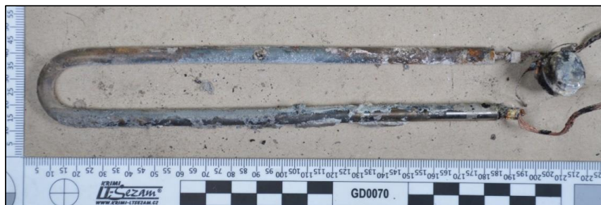
Obr. 1 Topné těleso ohřívače odebrané z požářiště
