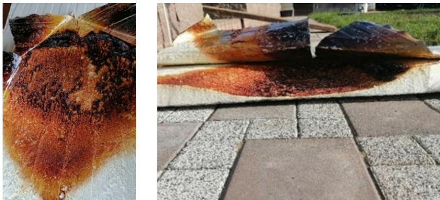
Obr. 4 Zmena vnútorného jadra a zmena hrúbky PUR panelu
