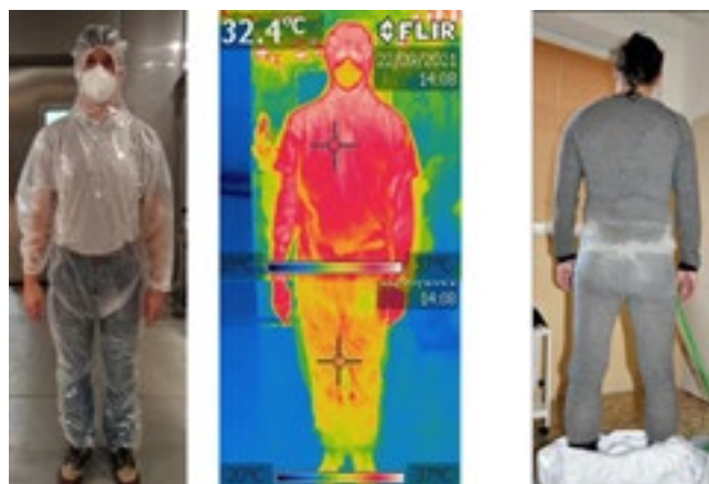
Obr. 10 Dobrovolník v oděvu proti Covidu 19 a termofotografie stavu pod oděvem. Obrázek vpravo ukazuje stav pod Tyvekem při testu v klimatické komoře o teplotě 30 \text{ }^\circ\text{C} a r.h. 23 % po 30 a zátěži cca 200 \text{ W.m}^{-2} po 30 minutovém experimentu.
