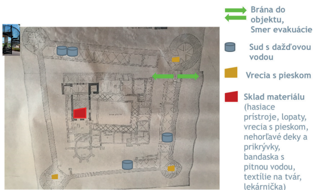
Obr. 5 Prezentácia základných opatrení na vybavenie pre požiarnu bezpečnosť hradu Bzovík prezentovaná na pôdoryse hradu, ktorý je uložený na Obecnom úrade Bzovík
