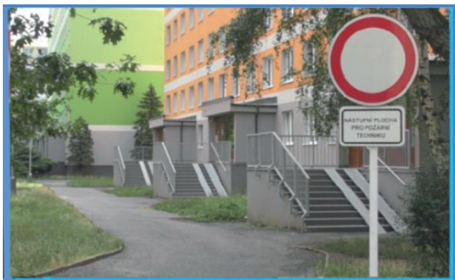
Obr. 5 Beroun, ulice Tovární č. p. 80 - 82, příklad zajištění rychlého a efektivního vyřešení příjezdu a ustavení požární techniky instalací/obnovou doplňkové tabulky s textem „Nástupní plocha pro požární techniku“ pod současnou dopravní značku „Zákaz vjezdu všech vozidel“. Nahoře foto listopad 2018, dole červenec 2019
